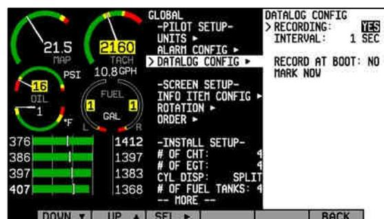
Si vous souhaitez marquer un enregistrement en un point particulier, appuyez sur le bouton SEL. Cela permet de retrouver plus rapidement la position dans l'enregistrement. Avec un enregistrement à 1 seconde, l'EMS-D120 peut consigner jusqu'à deux heures de données sur sa mémoire interne. Avec un enregistrement à 60 seconde, l'EMS-D120 peut emmagasiner jusqu'à 120 heures de données. Lorsque la mémoire est pleine, l'enregistrement continue en effaçant les précédentes données au fur et à mesure.
